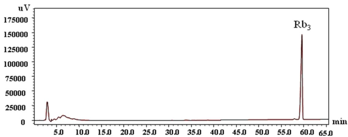
图A.2 人参皂苷 Rb<sub>3</sub> 对照品液相图
